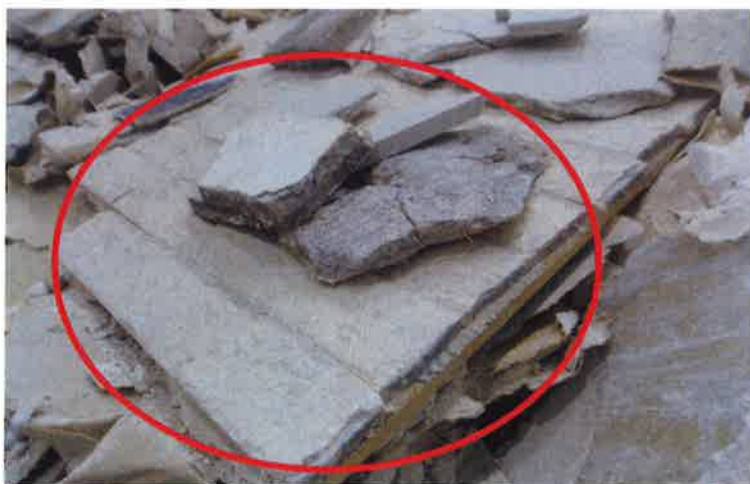
異物混入物。 サイディング(外壁材)が付 着又は混入しているもの。
